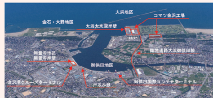
大浜大水深岸壁(-13m) (水深12mで併用) 出典：石川の土木 2022
